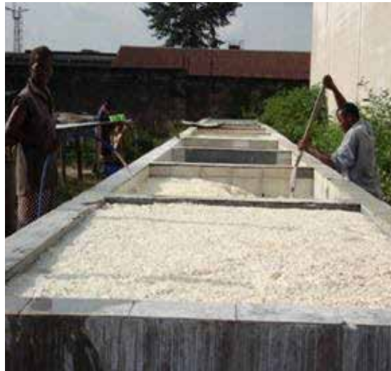
Photo 7.45. Bacs de rouissage remplis des micro-cossettes (Matchem, 2008).
