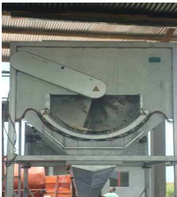
Photo 7.41. Eplucheur DORNOW, capacité optimale 50 tonnes des racines tubéreuses Mfumu Kento, Plateau de Bateke.
