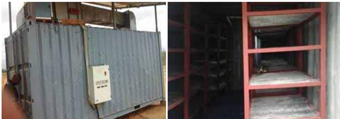
Photo 7.48. Vue extérieure et intérieure du séchoir cabinet de Kinkanzi/Muanda, Kongo Central.
